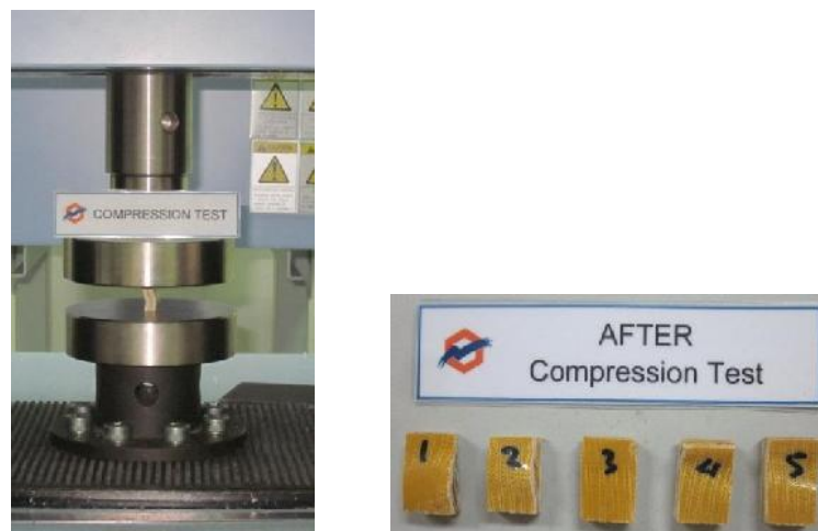
Gambar 1 Proses Pengujian Sampel Uji Tekan
