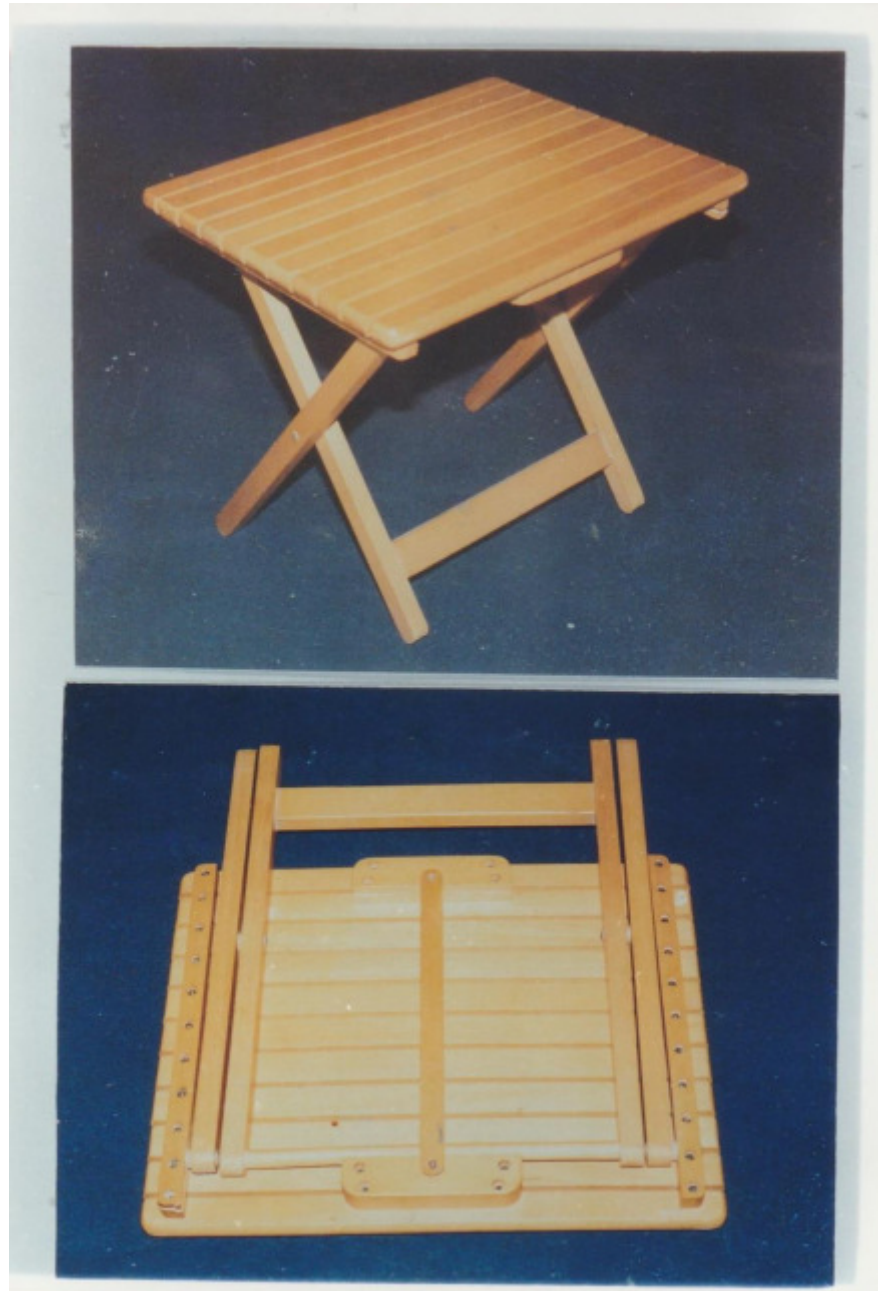
Gambar 51. Desain meja lipat ( folding table ) yang terbuat dari kayu ramın, daun mejanya salur-salur ( slated ). Meja lipat mudah dicangking . Terkesan ringan, ramping, ringkas, kecil, dan praktis. Ukuran meja 49 x 38 x 41 cm. Desain meniru dari desain yang dibawa konsumen Amerika dan Eropa. Produksi PT. Bumi Indah Raya Tangerang tahun 1990. (Foto: Eddy Supriyatna, 1999).
