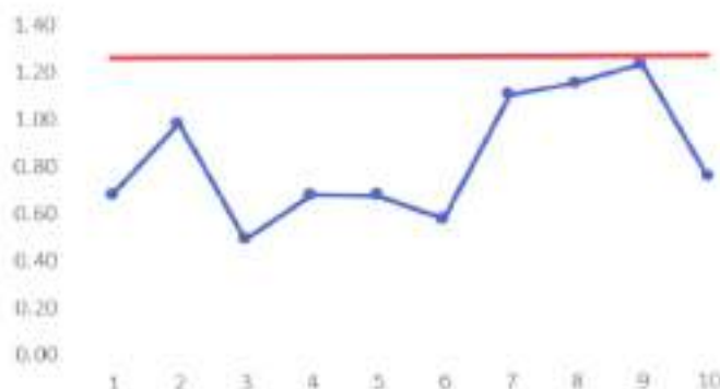
Gambar 8.2. Diagram kontrol GV versi klasik Tahap II untuk Contoh 8.2
