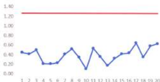
Gambar 8.1. Diagram kontrol GV versi klasik Tahap I untuk Contoh 8.1
