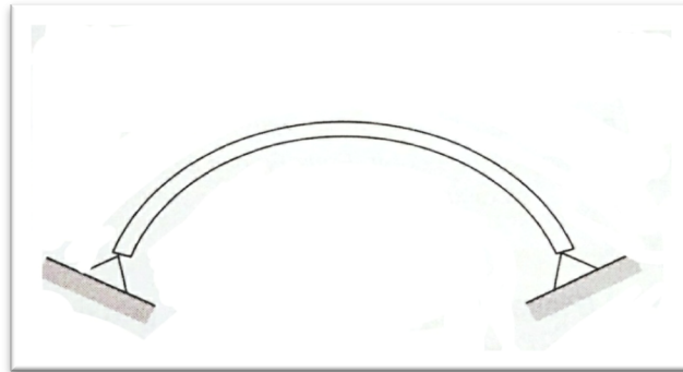
Gambar 1.1 a. Balok sederhana b. Balok menerus c. Balok melengkung [3]
