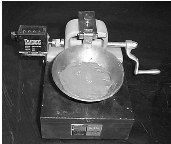
Gambar 11.9. Alat pengujian Atterberg Limit Test [6]
