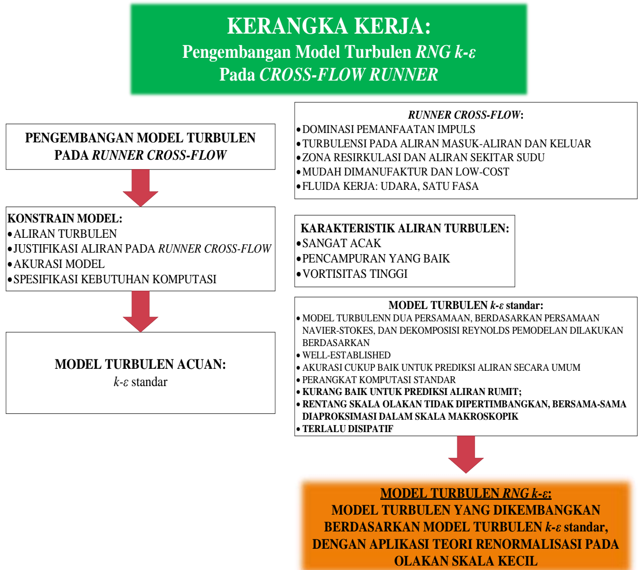
Gambar 1.12. Kerangka kerja pemilihan model turbulen RNG\ k-\epsilon
