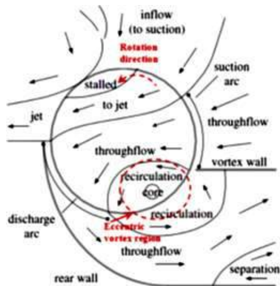
Gambar 1.10. Zona aliran dalam runner cross-flow oleh Sun et.al [37]
