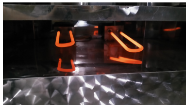
Gambar 7. Posisi Elemen Pemanas Mesin Oven Pengering
