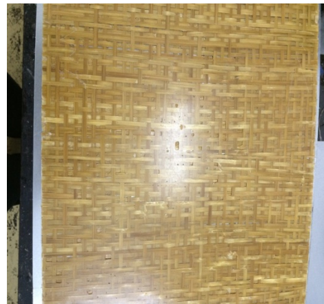
Gambar 7. Komposit anyaman plain setelah proses manufaktur
