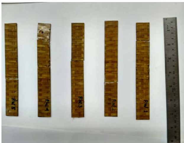
Gambar 10. Spesimen hasil uji tarik anyaman plain
