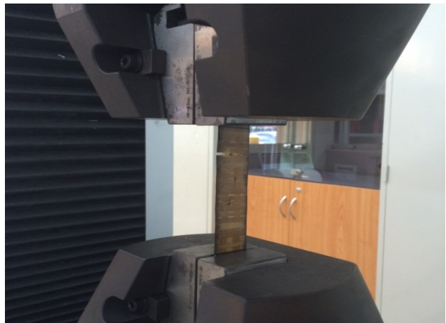
Gambar 9. Proses uji tarik komposit
