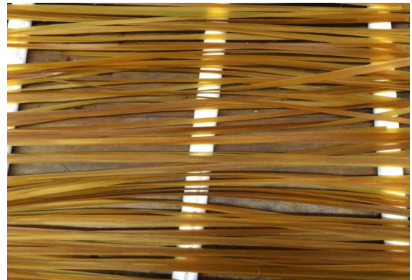
Gambar 5. Proses pengeringan serat bambu pada temperatur ruang
