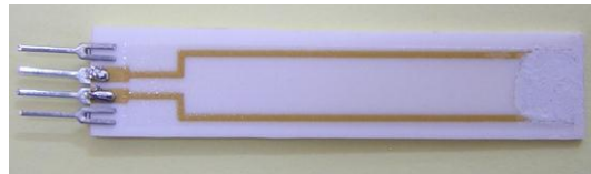
Gambar 12. Prototipe Sensor gas CO yang telah dilapisi \text{SnO}_2
