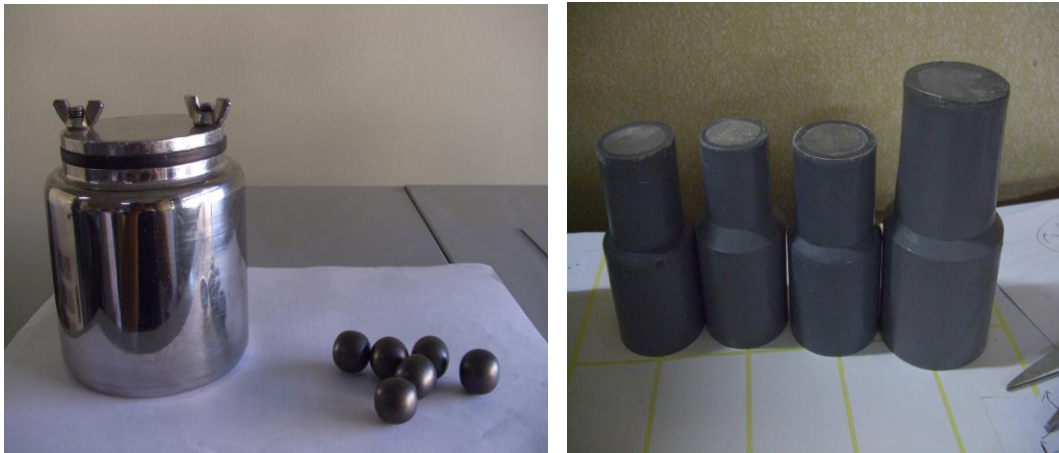
Gambar 3. (a) Bagian jar dan bal mill. (b) stack mesh filter 325
